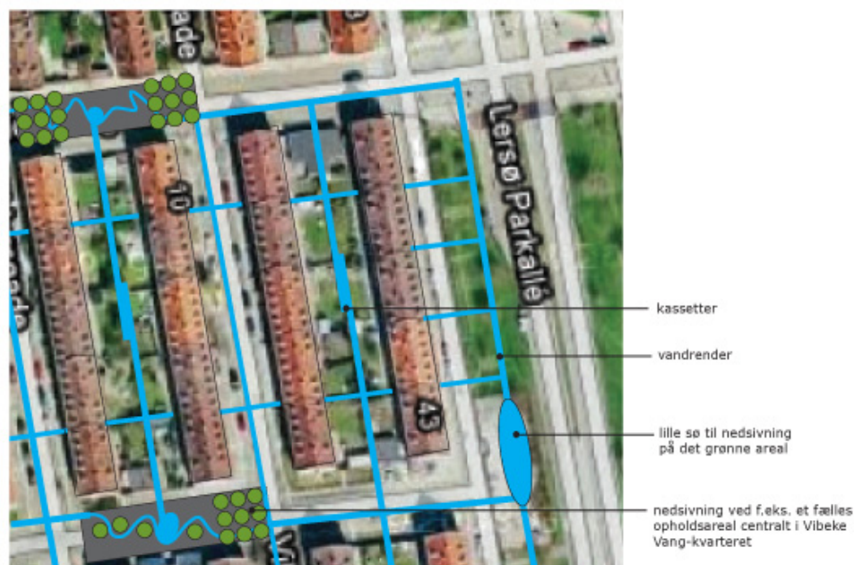
Figur 1: Principskitse for etablering af Lokal Afledning af Regnvand i Vibekevang. Etablering af en sti og nedsivning i et centralt forløb i baghaverne er en mulighed.
